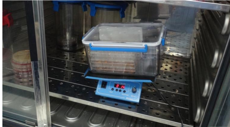
Şekil 3-7: Bakterilerin anaerop ortamda, Çalkalama makinesi'nde(çalkalayıcı) inkübe edilmesi
