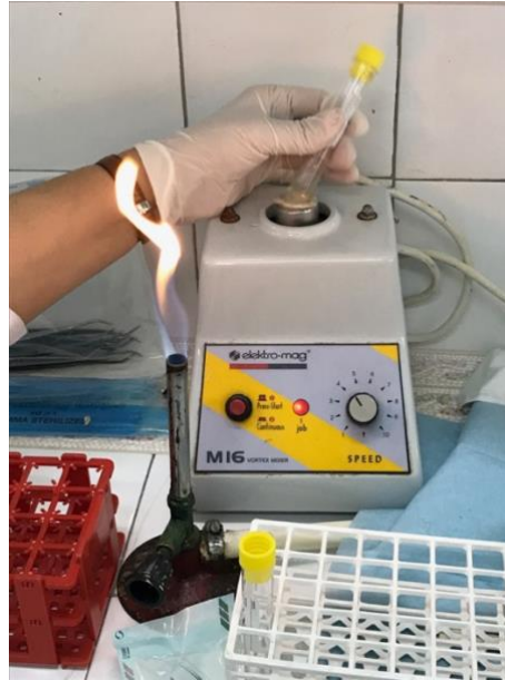
Şekil 3-8: Tüplere konulan disklerin vortekslenmesi
