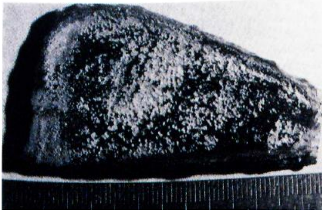
Şekil 3.12: Çok küçük (0.1-0.2 mm) çukur oluşumu
