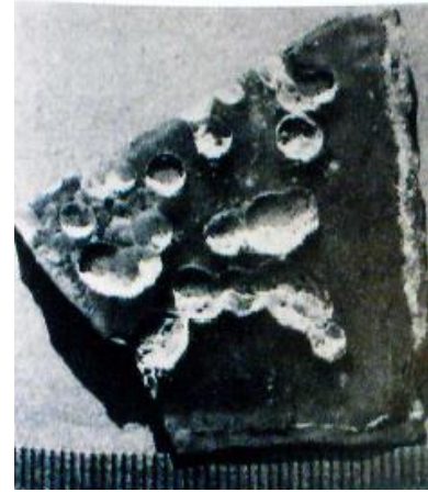
Şekil 3.13: Beyaz birikimli büyük (<5 mm) çukur oluşumu
