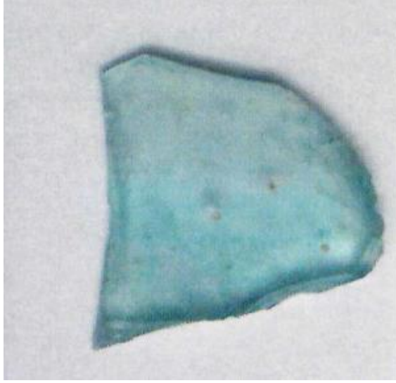
Şekil 3.5: Camda matlaşma örneği (Caner-Saltık, 2012: 59)
