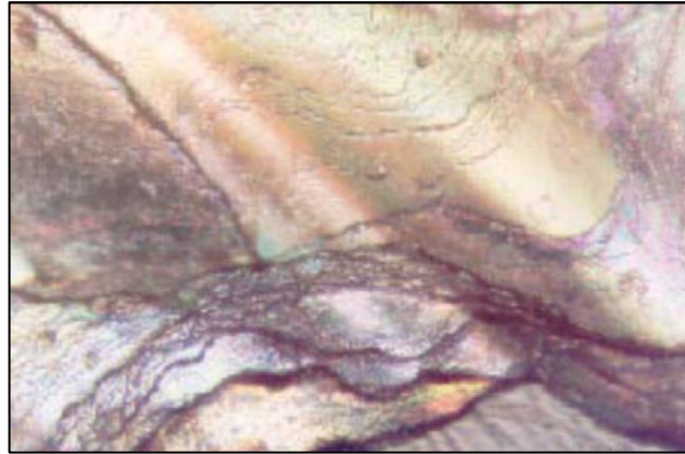
Şekil 3.7: Cam yüzeyinde birkaç tabakadan oluşan yapraklanma (Lampropoulos vd., 2004: 44)
