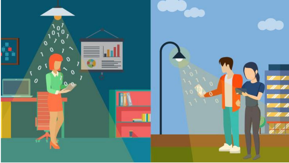
Şekil 64: Li-Fi Teknolojisini: Veri iletmek için Işık Kaynakları Kullanılır 316
