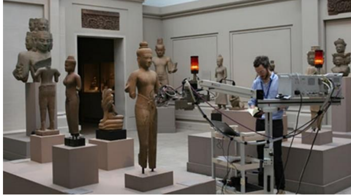
Fotoğraf 36: Taşınabilir X-Işını Floresan Spektrometresi, Taş Eserler Üzerinde Yapılan Araştırmalar
