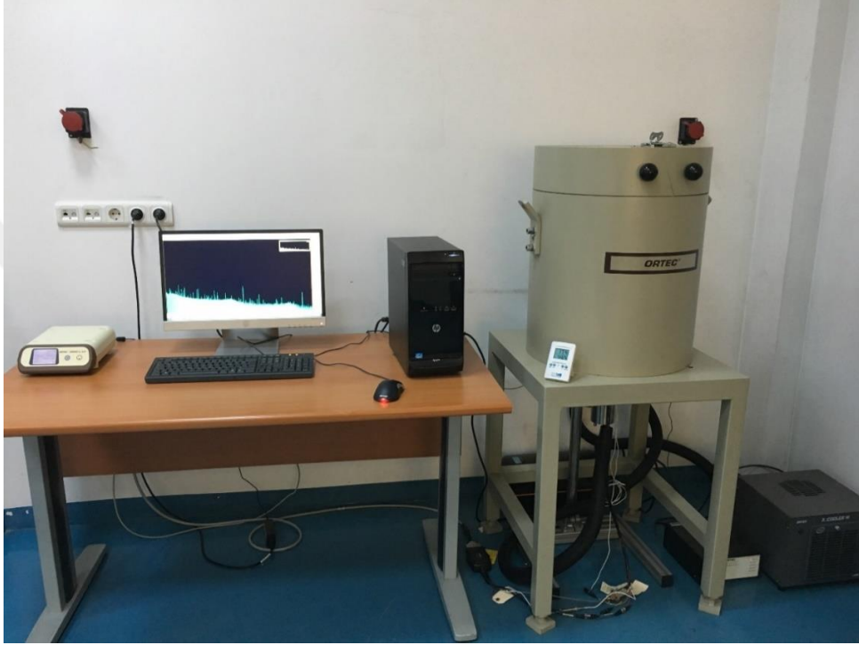
Şekil 3.7: İstanbul Üniversitesi Fen Fakültesi Nükleer Fizik Anabilim Dalı Nükleer Fizik Gama Spektroskopi Laboratuvarı'nda bulunan dedektör sistemi.
