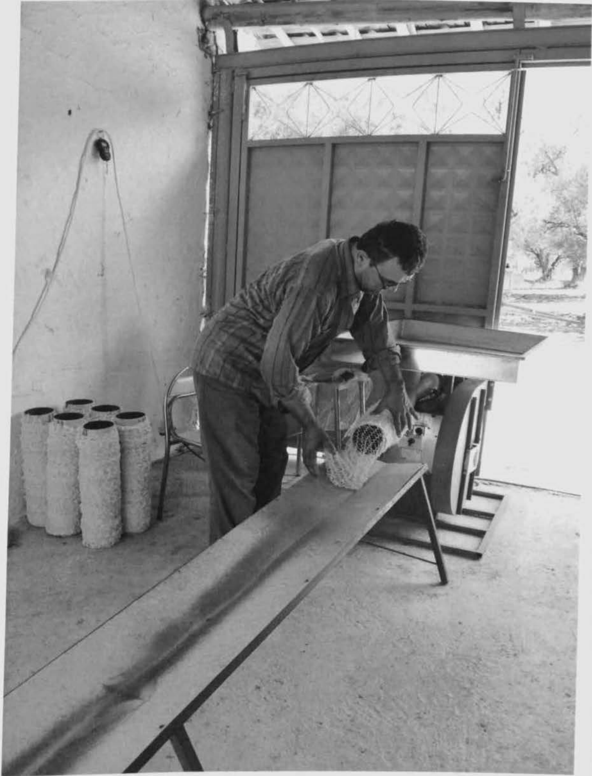
Fotoğraf 6: Köydeki bir başka hane ise tütün kurutma işlemi için makineyi tercih etmektedir. Öncelikle makineye tütün yapraklarını doldurmak için bir file geçirilir.
