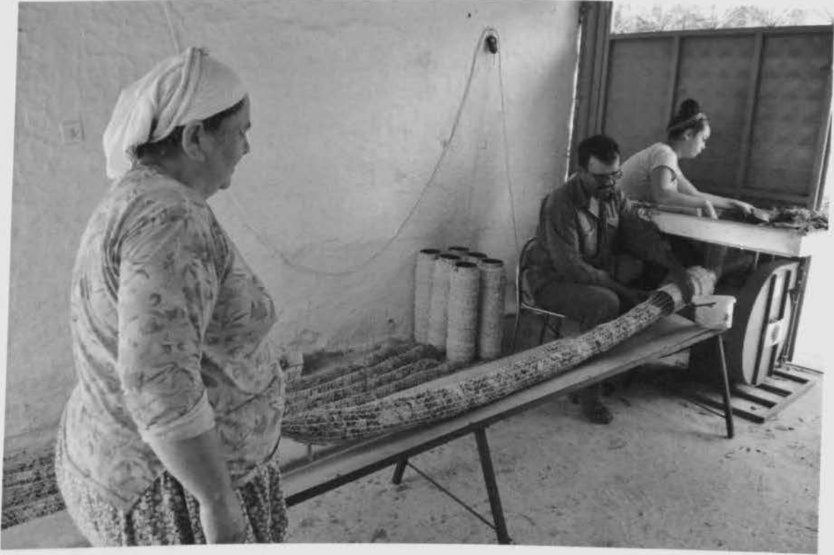
Fotoğraf 8: Bu tütün makinenin başında 3 kişi çalışmaktadır. Bir kişi tütün yapraklarını makinenin içine gönderir ve diğer iki kişi ise fileyi tutar. Makine, tütün yapraklarını filenin içine doldurur.
