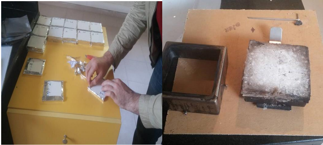
Şekil 3.9: Yanma deneyi örneklerinin alüminyum folyo ile kaplanması.
