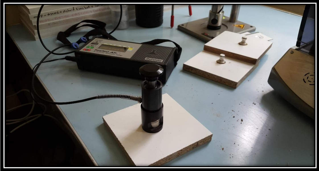
Şekil 3.23: Örneklerin test cihazına yerleştirilmesi ve çekme işleminin gerçekleştirilmesi.
