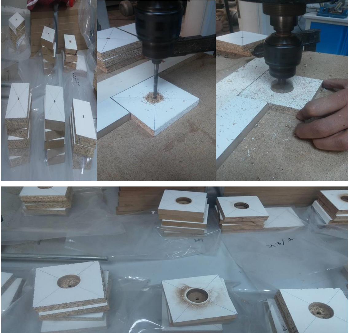
Şekil 3.17: Aşınma direnci için numunelerin hazırlama işlemi.
