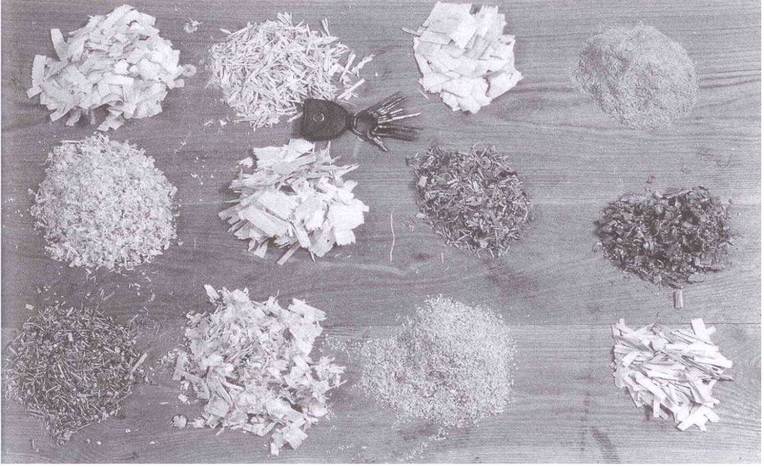
Şekil 2.1: Yongalevha üretiminde kullanılan çeşitli tip yongalar [9].
