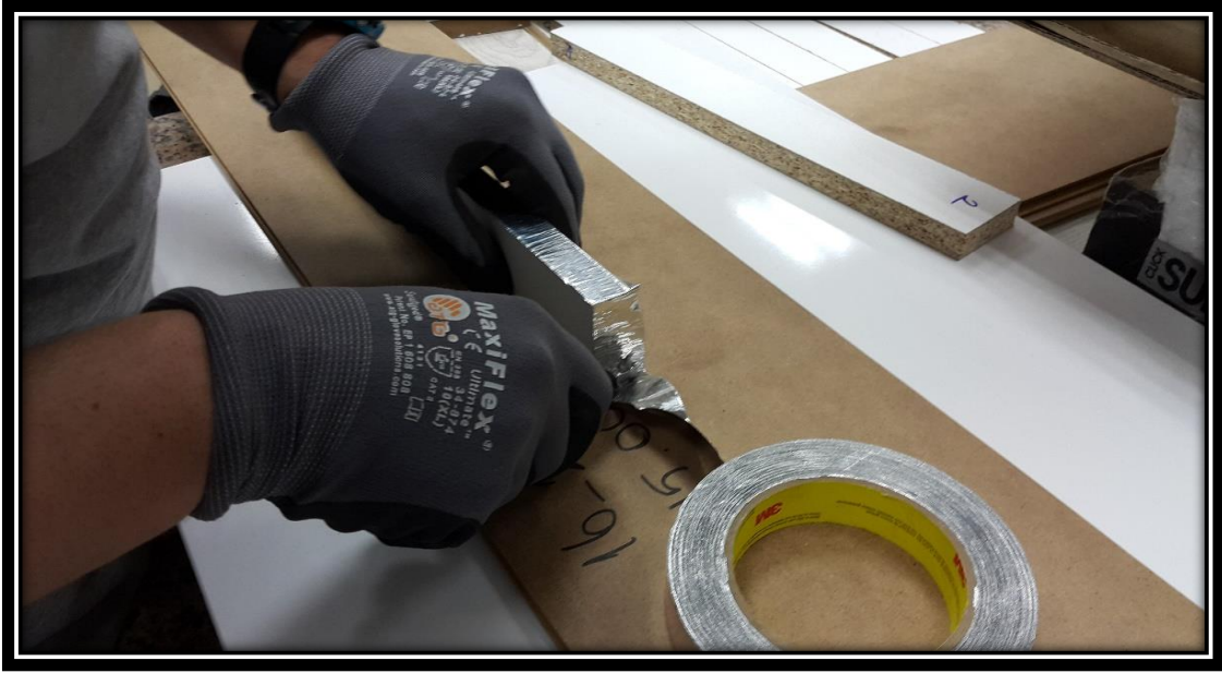
Şekil 3.13: Formaldehit emisyonu için hazırlanan örneklerin kenarlarının kaplanması.
