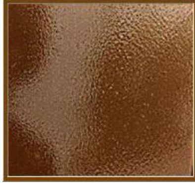
Şekil 2.38: Toz boya uygulaması sonucunda meydana gelen portakal görüntüsü [37].
