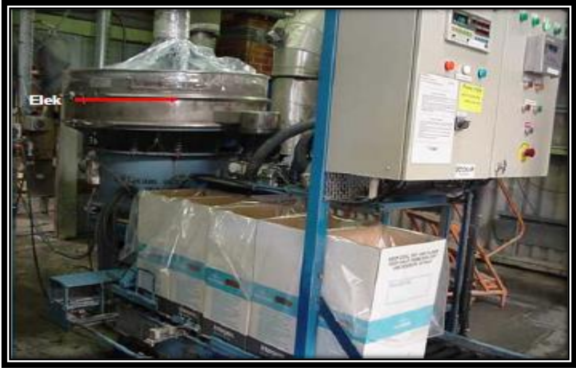
Şekil 2.15: Elekten geçme, tartılma ve paketlenme [33].
