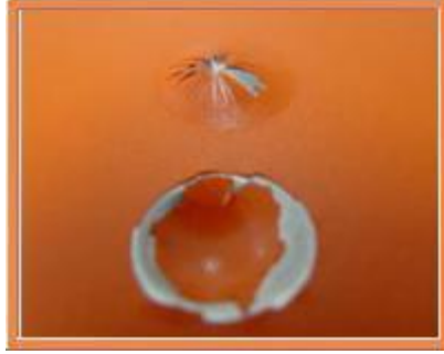
Şekil 2.41: Düşük mekanik dayanım gösteren toz boya uygulaması [37].
