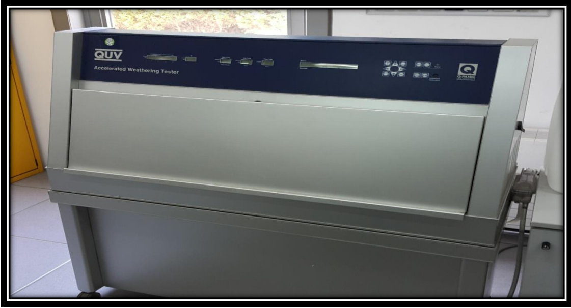
Şekil 3.25: QUV Hızlandırılmış yaşlandırma testi.
