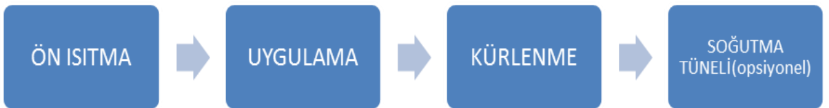
Şekil 2.55: Termal kürleme işlemi ile elektrostatik toz boya uygulama basamakları [56].
