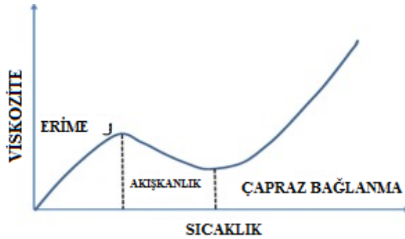
Şekil 2.52: Kürlenme esnasında film oluşum davranışı [102].
