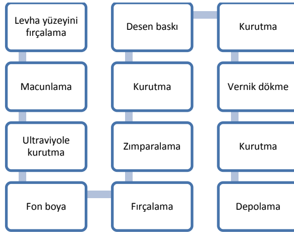
Şekil 2.6: Yongalevha üzerine desen baskı işleminin iş akışı.
