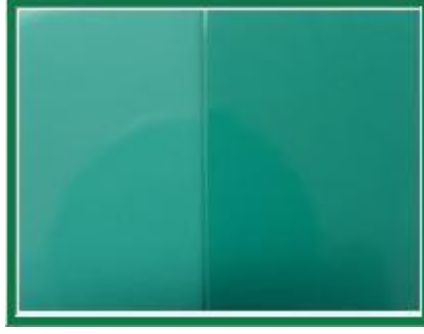
Şekil 2.39: Toz boya uygulaması sonucunda meydana gelen renk farklılığı [37].
