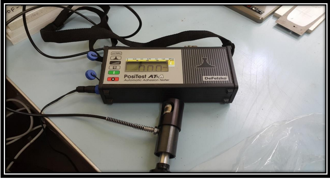
Şekil 3.20: PosiTest AT-A otomatik yapışma test cihazı.
