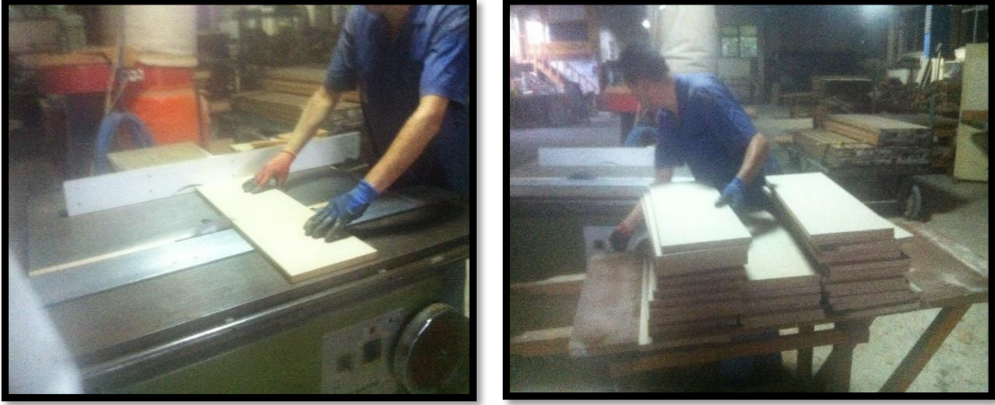
Şekil 3.1: Levhaların daire testerede ebatlama işlemi.
