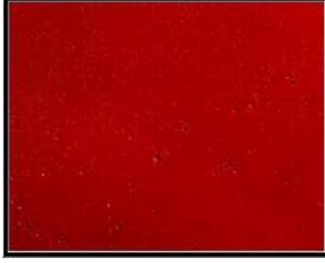
Şekil 2.36: Toz boya uygulaması sonucunda yüzeyde meydana gelen iğne delikleri [37].
