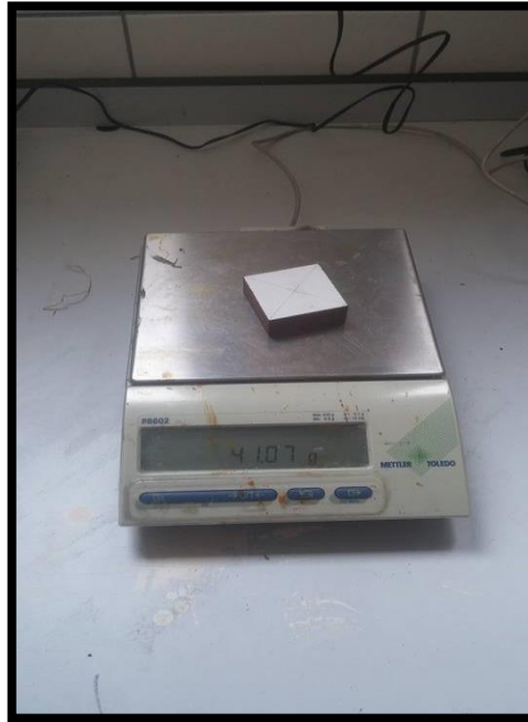
Şekil 3.12: Deney örneklerinin dijital terazi ile ağırlıklarının ölçülmesi.
