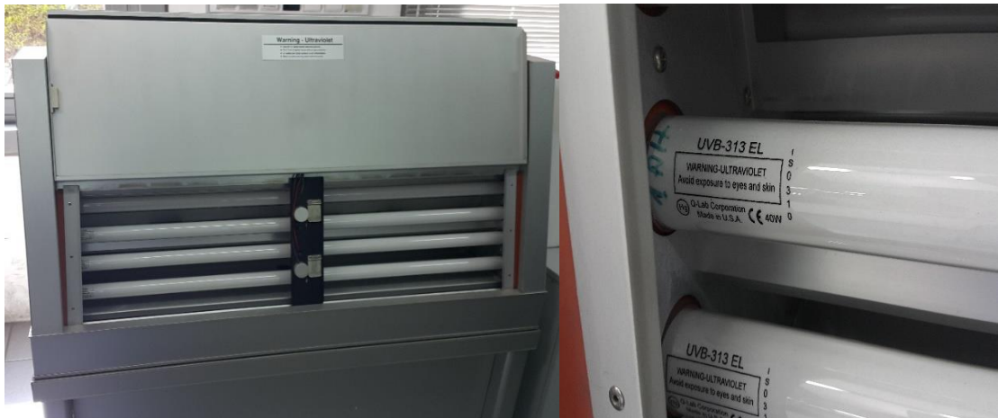
Şekil 3.28: Cihaza yerleştirilmiş UVB – 313 EL tipi lamba.
