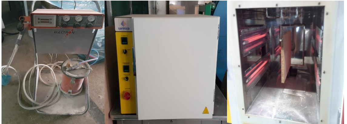
Şekil 3.3: Korona tipi elektrostatik toz boyama tabancası ve kızılötesi etüv.
