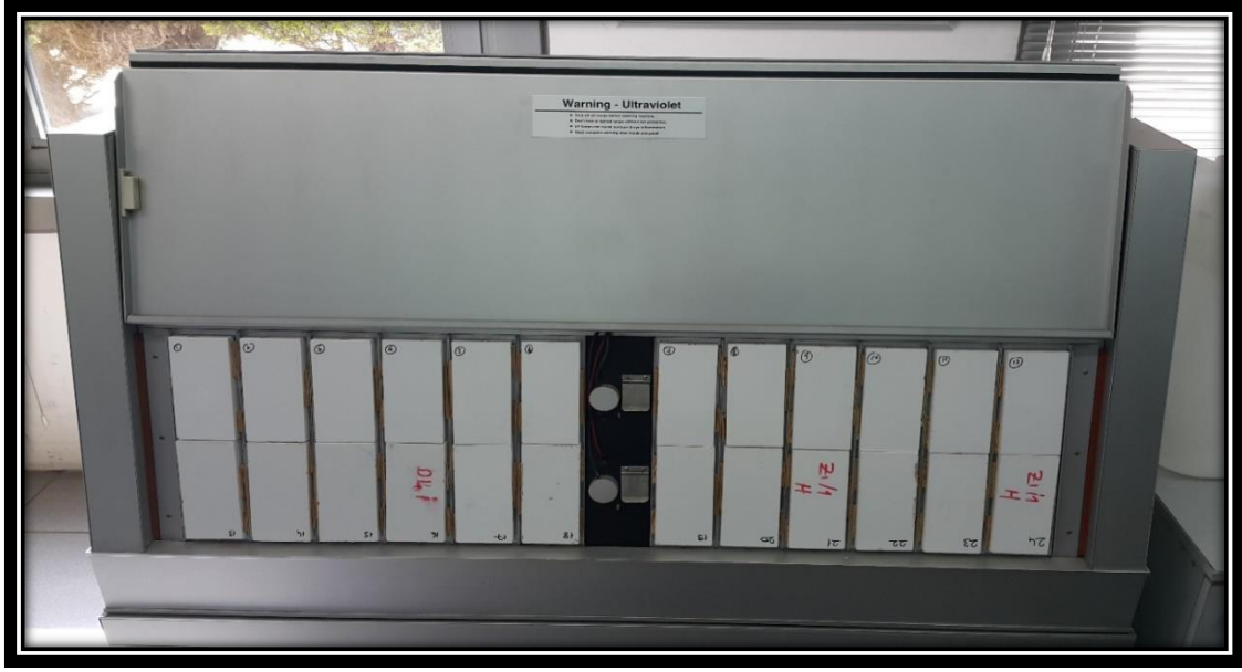
Şekil 3.27: Örneklerin QUV cihazına yerleştirilmesi.
