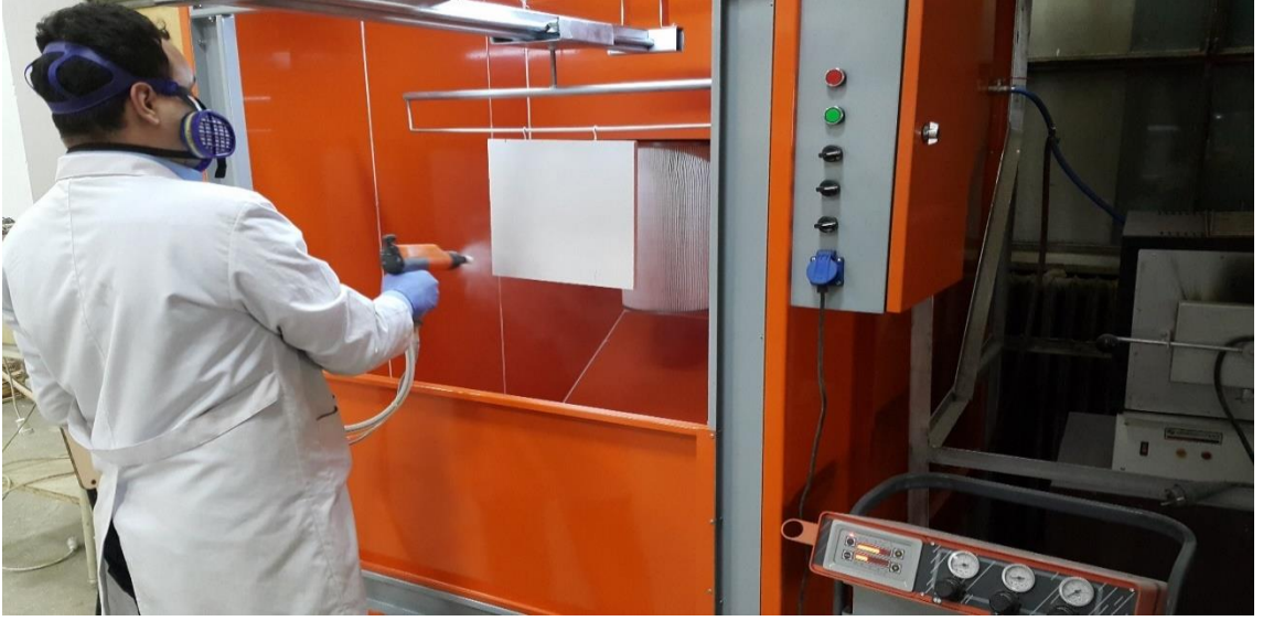
Şekil 3.2: Boyama kabini içerisinde 25×35 cm ebatlarında örnekler toz boya işleminin gerçekleştirilmesi.
