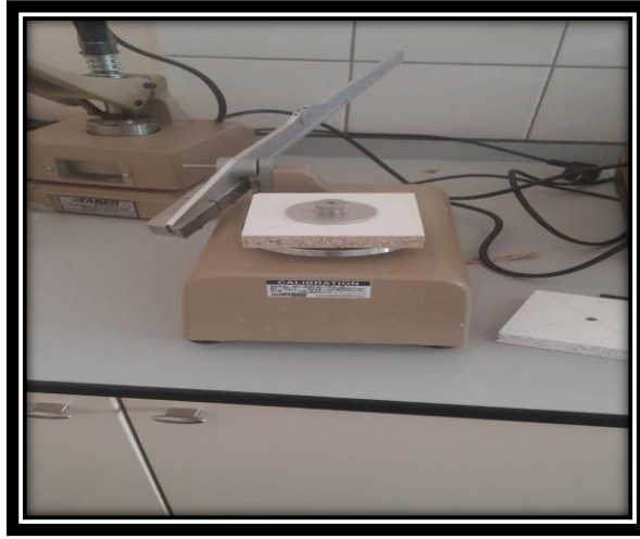
Şekil 3.15: Taber çizilme test cihazı.
