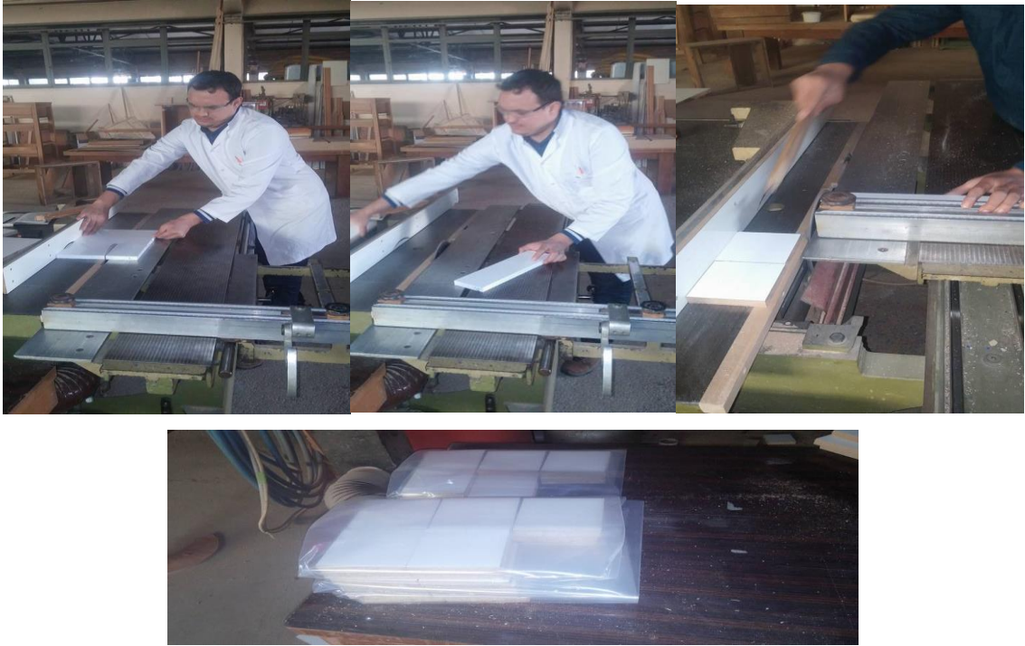
Şekil 3.5: Boyanmış örneklerin test standartlarına göre ebatlandırılması.
