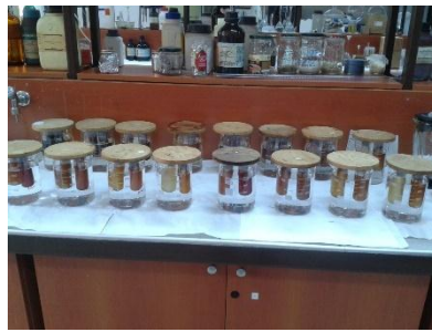
Şekil 3.15: Alkali, Asit ve Tuz Dayanım Test Sistemi.
