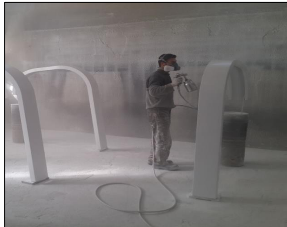
Şekil 2.5. Mobilya boyahanelerinde boya tabancası kullanımı
