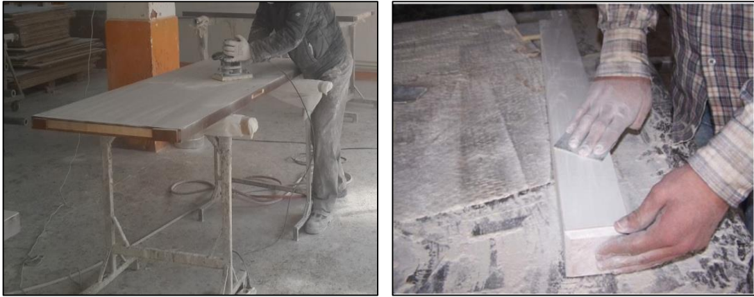
Şekil 2.6. Mobilya boyahanelerinde zımpara işlemi ve toz oluşumuna örnekler
