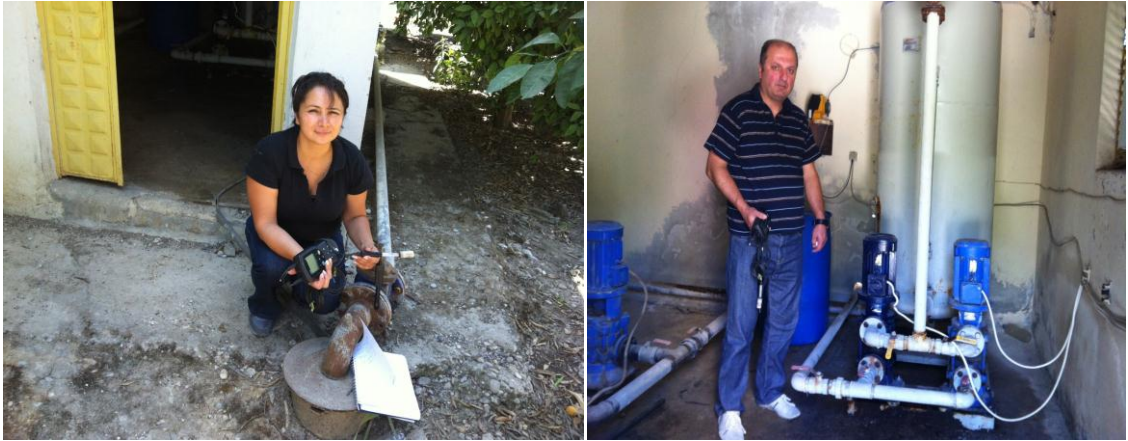
Şekil 3.1: Arazide multiprob cihazı ile yerinde yapılan ölçümler.
