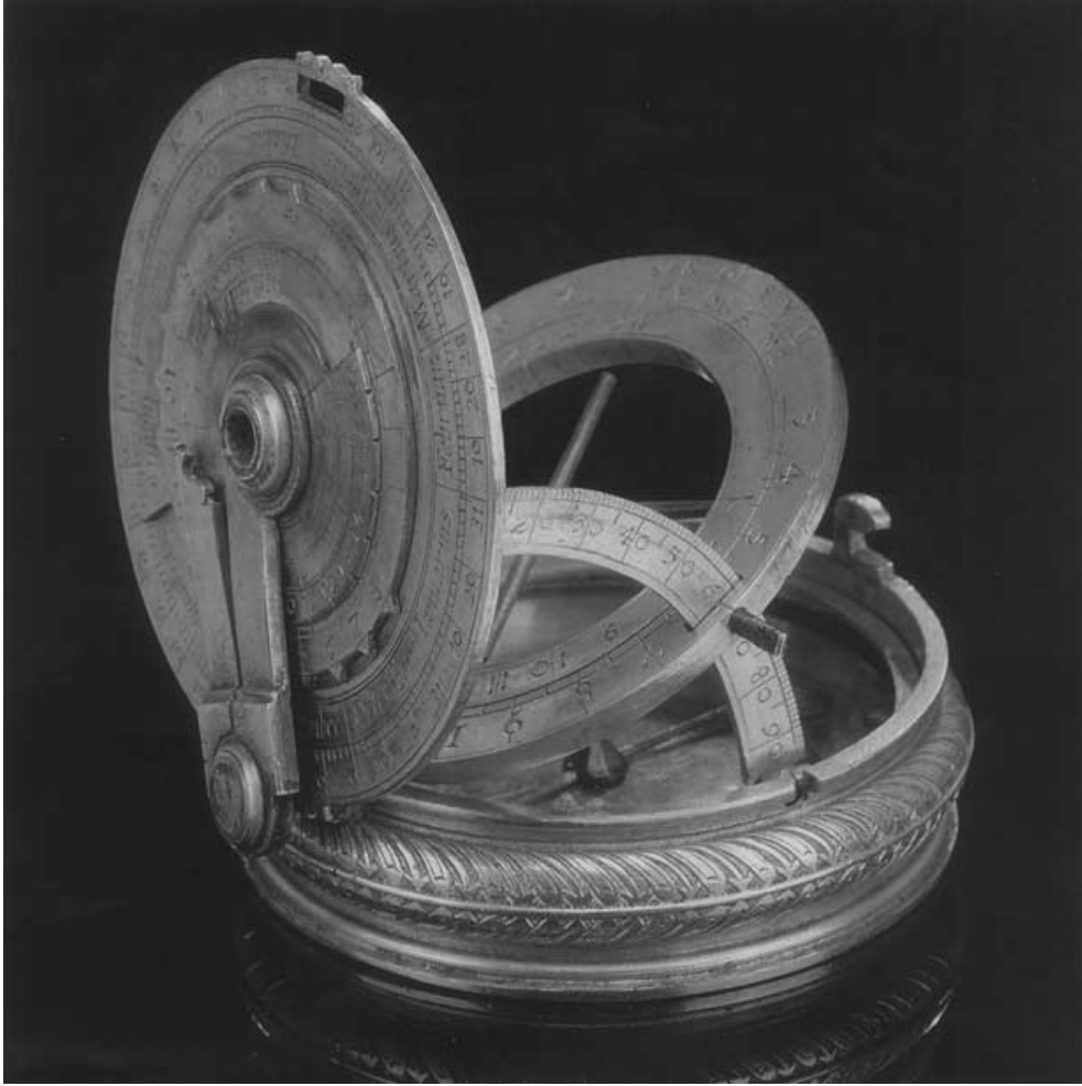
Resim 24 - Kapağında nokturnal bulunan bir küresel güneş saati.
