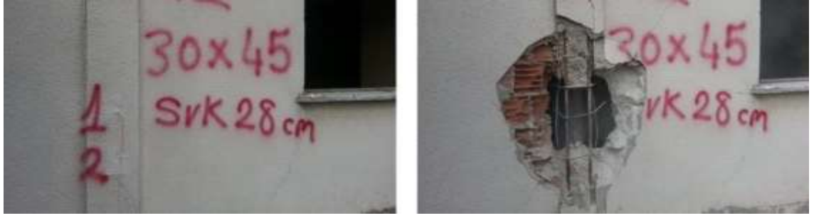
Şekil 4.14: 3.Deneme'de Atım Öncesi ve Sonrası Kolon Görüntüsü
