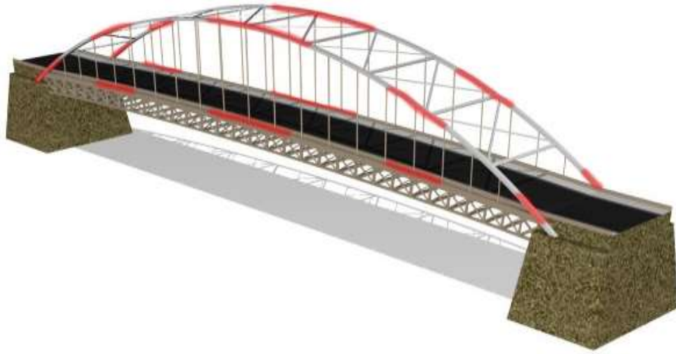
Şekil 2.34: Betonarme Köprüde Patlatma Bölgeleri
