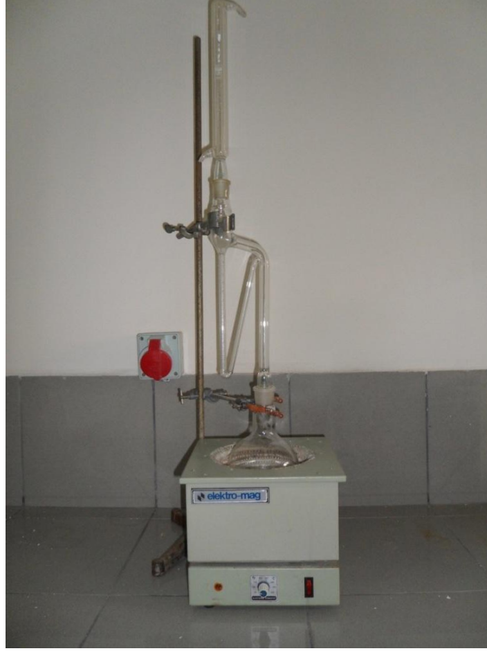
Şekil 3.4 : Clevenger tipi su destilasyonu aparatı
