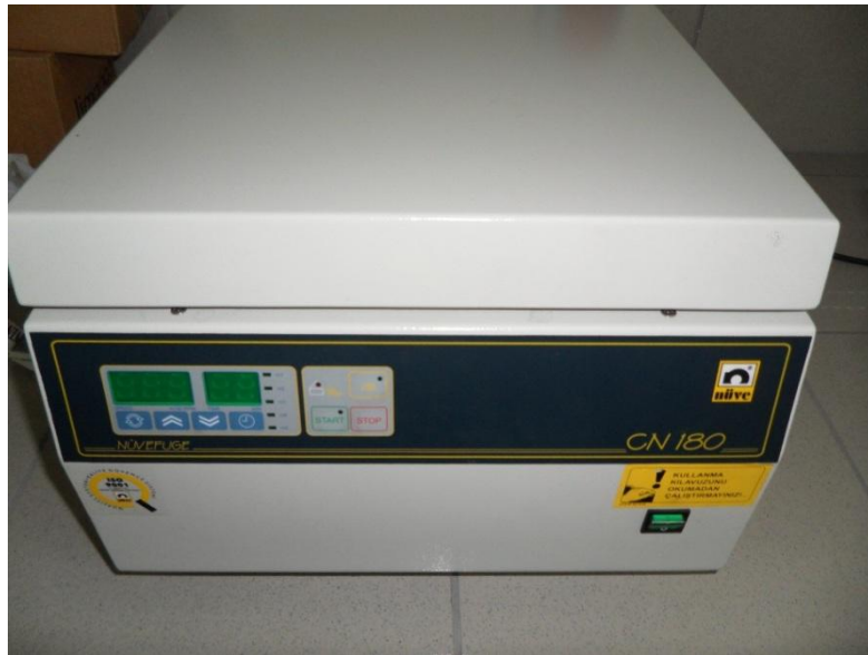
Şekil 3.5 : Denemelerde kullanılan Nüve CN180 model santrifüj
