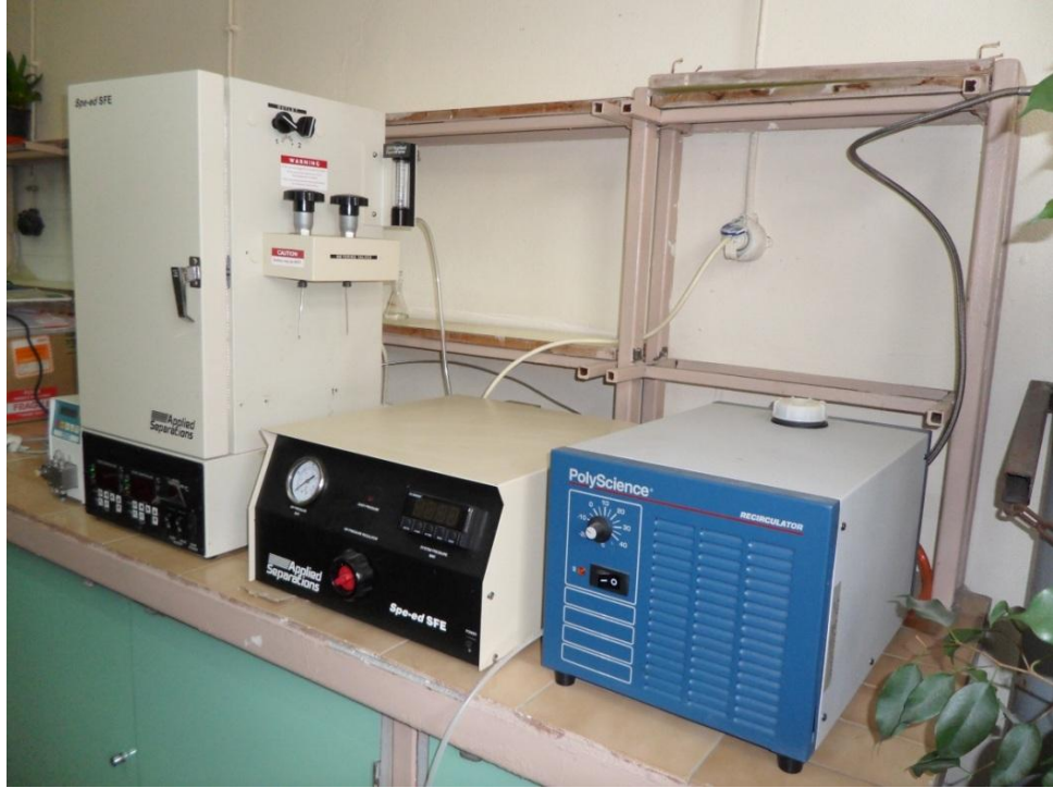
Şekil 3.7 : Süperkritik akışkan ekstraksiyonu cihazı
