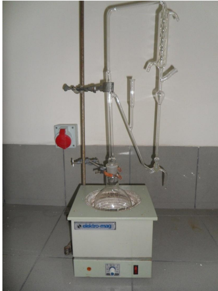
Şekil 3.6 : Uçucu yağ verim tayini aparatı
