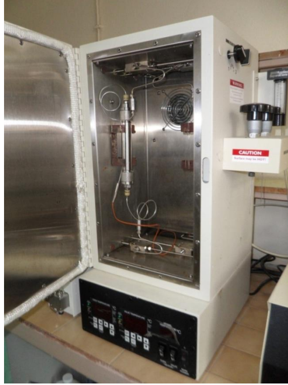
Şekil 3.8 : Süperkritik akışkan ekstraksiyonun da kullanılan 24 mL hacimli ekstraktör
