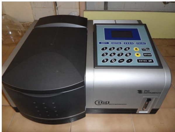
Şekil 3.9 : Antioksidan kapasitesi ve toplam fenolik madde tayinlerinde kullanılan UV spektrofotometre
