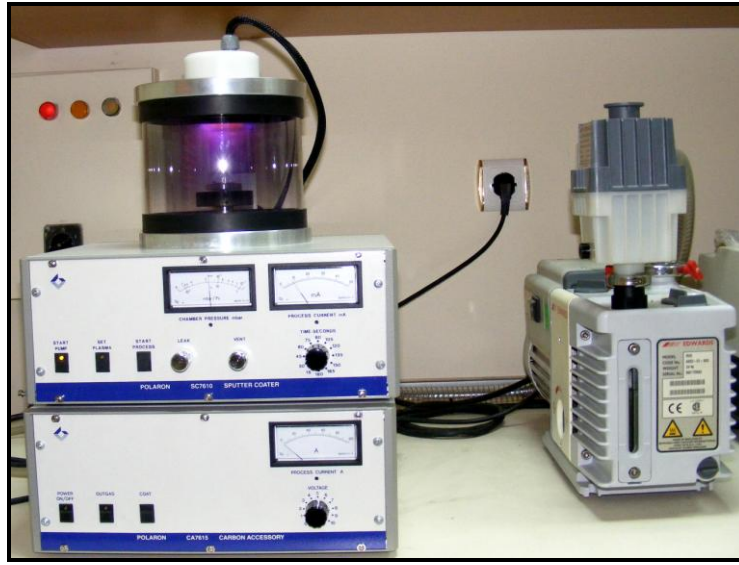
Şekil 3.3: Örnek Hazırlama Ünitesi: Polaron SC 7610 Marka Altın Kaplama Cihazı
