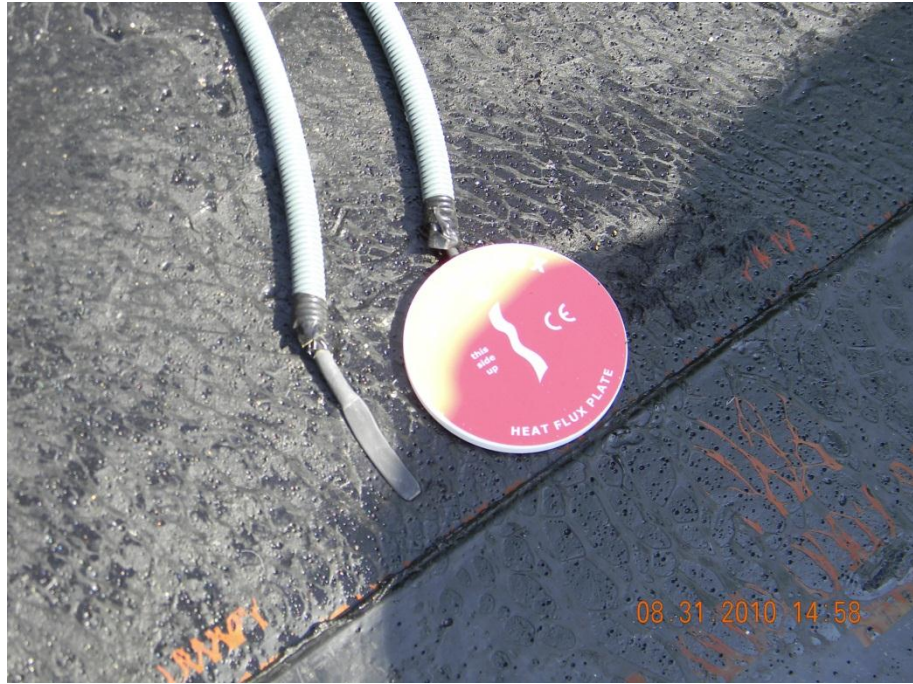
Ek-7.2.4 - Isı akısı ölçüm plakaları ve termočiftler
