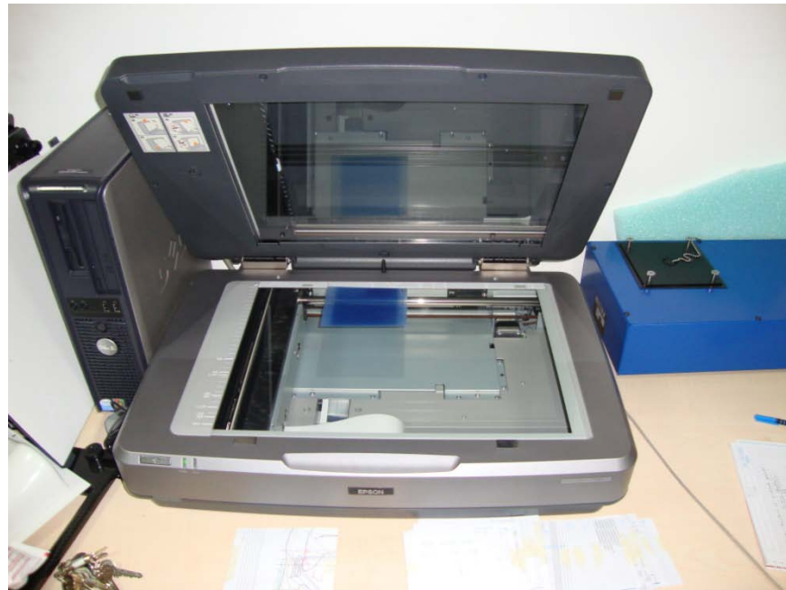
Şekil 3.72 Planlamalara Göre Işınlanan Filmlerin Taratılması
