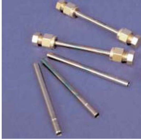
Şekil 4: Paslanmaz çelik sorbent tüplerin resimleri ve pirinç kaplama başlıkları.
