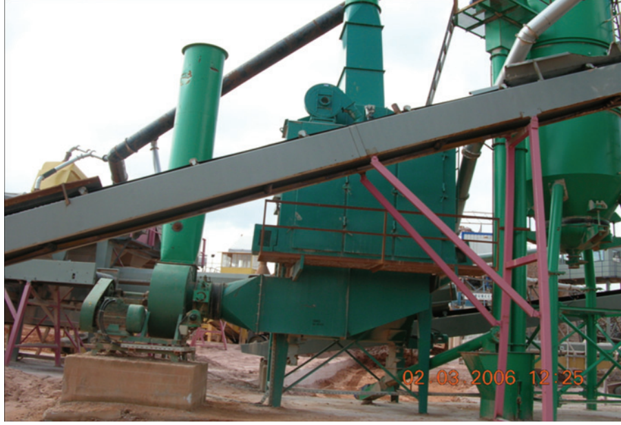
Şekil 2.10: Kapalı sistemde vakumla toz emisyonunun giderilmesi [6]
