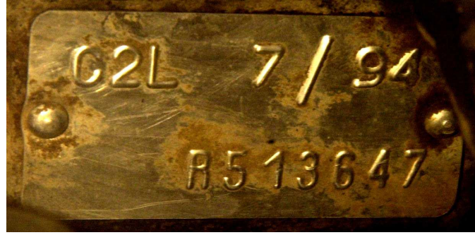
Resim. 3. Renault marka araçlara etiket şeklindeki motor numarasının perçinle sabitlenmiş görünümü
