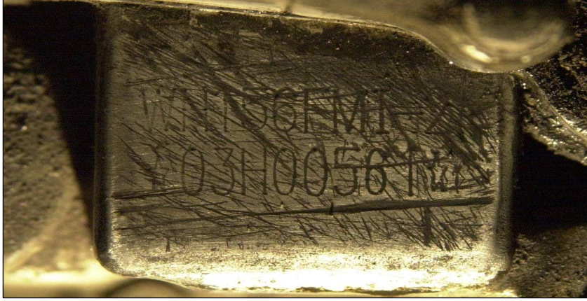
Resim.109. Motor numarasının incelemelerden sonraki hali
