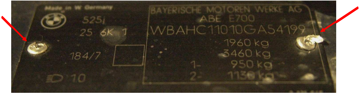
Resim.100. Sağ iç çamurluktaki tip plakası
