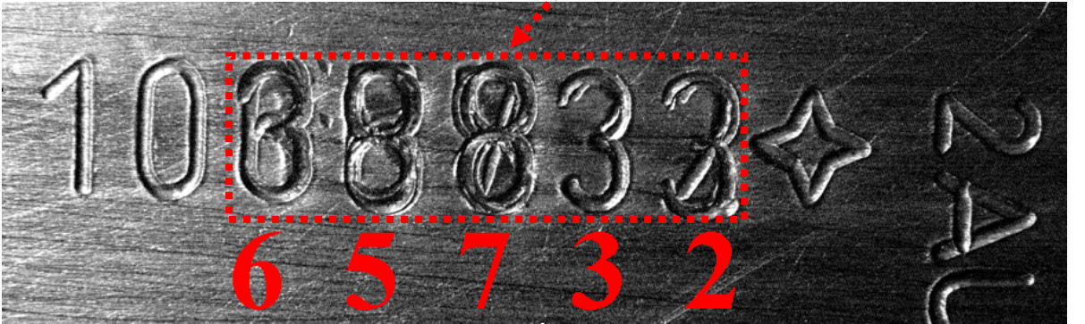
Resim.30. İnceleme sonrası şasi numarasında belirlenen tahrifatın ve orijinal numaranın görünümü
