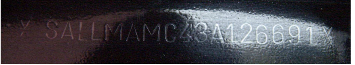
Resim.31. Sahte şasi numarasının incelemelerden önceki hali
