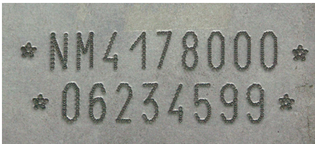
Resim.19. Nokta vuruş yöntemi kullanılarak yazılan şasi numarası
