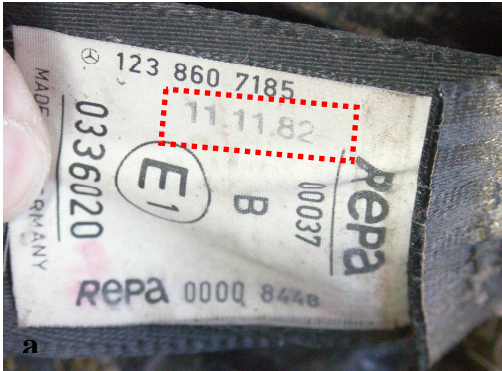
Resim.70. Emniyet kemer etiketleri üzerindeki tarih kodlaması
