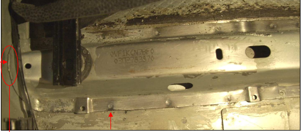
Resim.92. Şasi numarasının bulunduğu taban sacı üzerindeki parçanın bağlantı noktalarının incelemelerden sonraki görünümü
