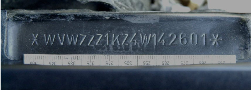
Resim.35. Sahte şasi numarasının incelemelerden önceki hali
