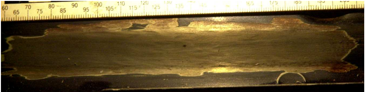
Resim.96. Aracın orijinal şasi numarasının bulunması gereken bölge
