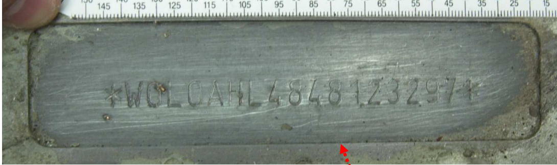
Resim.44. Şasi numarasının üzerindeki boya ve kimyasal astar kaldırıldıktan sonrasındaki hali
