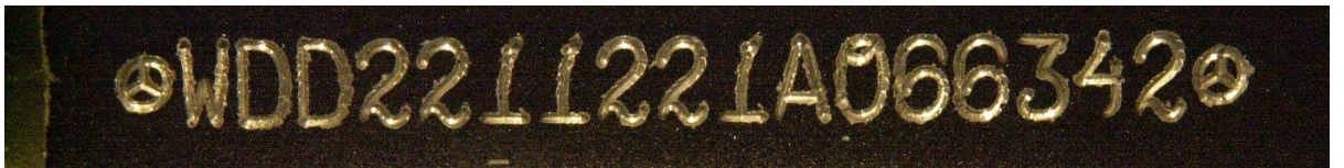
Resim.27. Kazıma yöntemi kullanılarak yazılan şasi numarası
