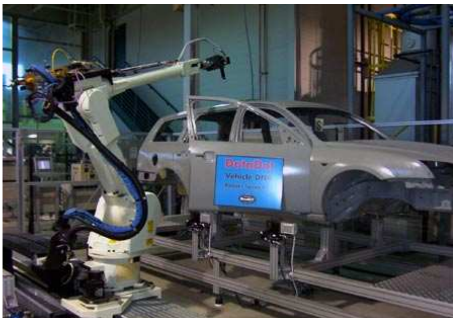
Resim.16. DataDotDNA robot sprej püskürtme sistemi (13)
