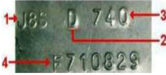
Resim. 1. Renault marka araçlara ait etiket şeklindeki motor numarası(17)
