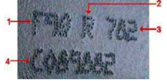
Resim. 2. Renault marka araçlara ait nokta vuruş yöntemiyle yazılmış motor numarası (17)
