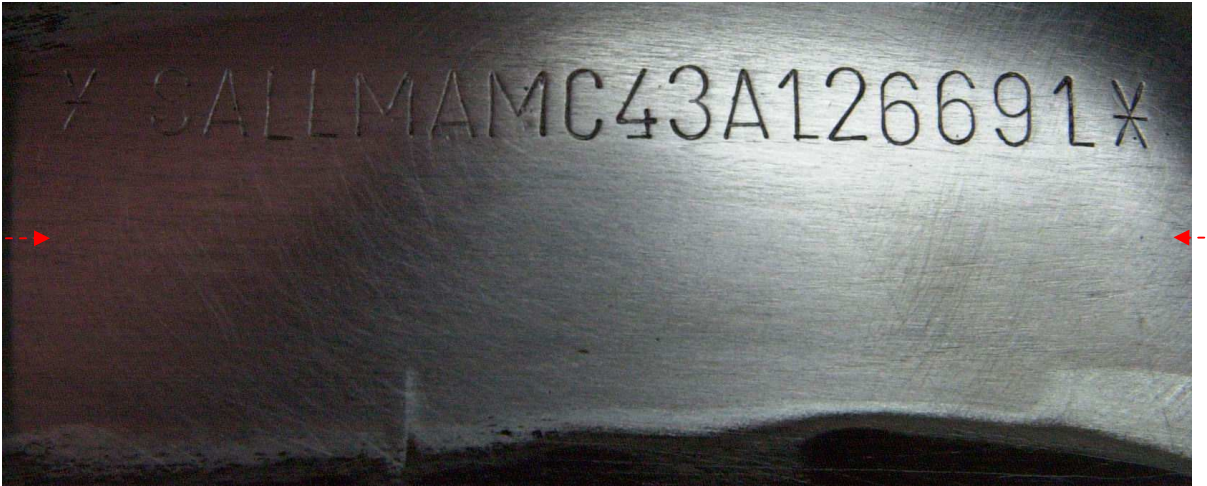
Resim.32. Sahte numara bulunan bölgenin boya ve kimyasal astar kaldırıldıktan sonraki hali
