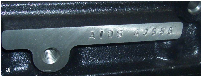
Resim.22. Numarator aletleri kullanarak pres(baskı) yöntemiyle elle vurulan motor numarasının ve kullanılan aletlerin görünümü
