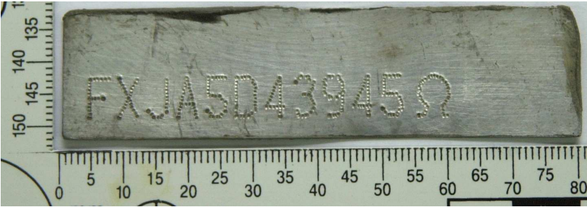
Resim.47. Plaka haline getirilen ve çalıntı araca yapıştırılan orijinal motor numarasının görünümü
