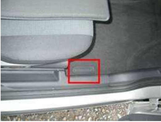
Resim.42. Şasi numarasının sağ ön yolcu koltuğu altı taban sacı üzerinde bulunduğu yerin görünümü.
