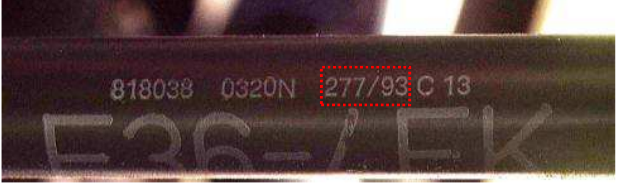
Resim.69. Arka bagaj hidrolik rotları üzerindeki tarih kodlaması
