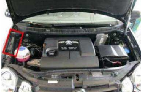
Resim.34. Şasi numarasın sağ ön çamurluk sacı üzerinde dikey olarak bulunduğu yerin görünümü
