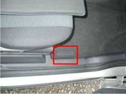
Resim.28. Şasi numarasının sağ ön yolcu koltuğu altı taban sacı üzerinde bulunduğu yerin görünümü
