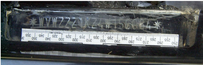
Resim.37. Plakanın altına gizlenen orijinal şasi numarasının görünümü
