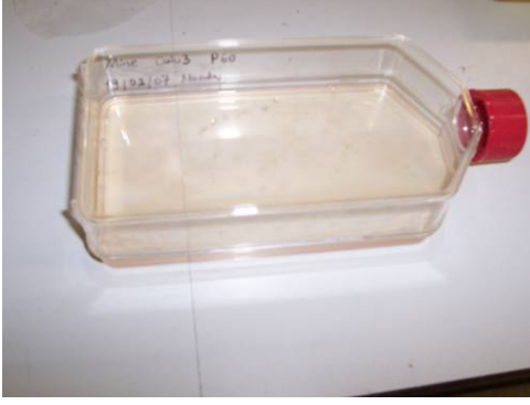
Şekil 3 : 162 cm 2 taban alanına sahip havalandırmaya elverişli (ventilated) hücre kültürü erleni
