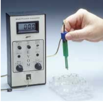
Şekil 12 : Transepitel elektrik direncini ölçen çubuk elektrodla sahip EVOM voltmetreye ait şekil (STX-2 and Evom G, World Precision Instruments, Stevenage, UK)
