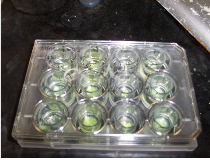
Şekil 14 : Floresanslı nanopartikül nanopartikül geçiş çalışmalarında kullanılan herbir kuyucuğu 12 mm çapında 1,12 cm 2 membran büyüme alanına sahip hücre kültürü çalışmaları için işlem görmüş 12 kuyucuklu Transwell geçirgen hücre kültürü destek kabına ait fotoğraf
