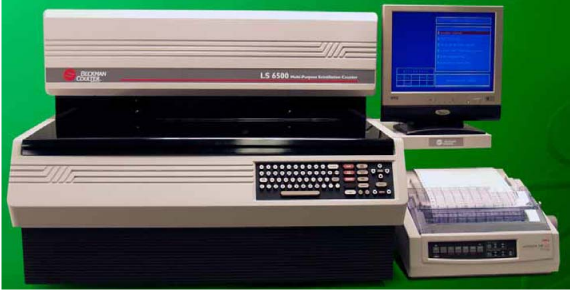
Şekil 13 : Sıvı ışıma sayacına ait şekil (Multi-Purpose Liquid Scintillation Counter LS 6500) (Beckman Coulter, USA)
