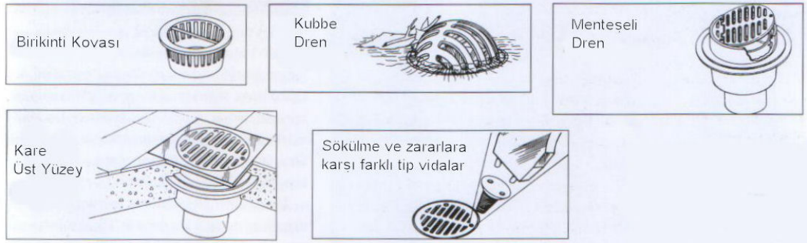
Şekil 4.9 : Çatı bahçelerinde dren tipleri[6].
