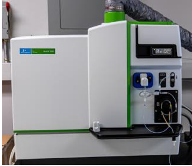
Şekil 3-13: İndüktif Eşleşmiş Plazma Kütle Spektroskopisi (ICP-MS) (Perkin Elmer, Nexion 1000 ICP-MS)
