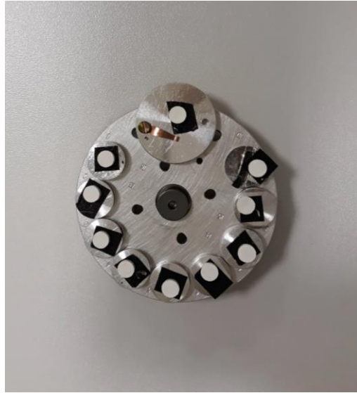
Şekil 3-6: SEM-EDS deneyi için materyallerin yerleştirilmesi
