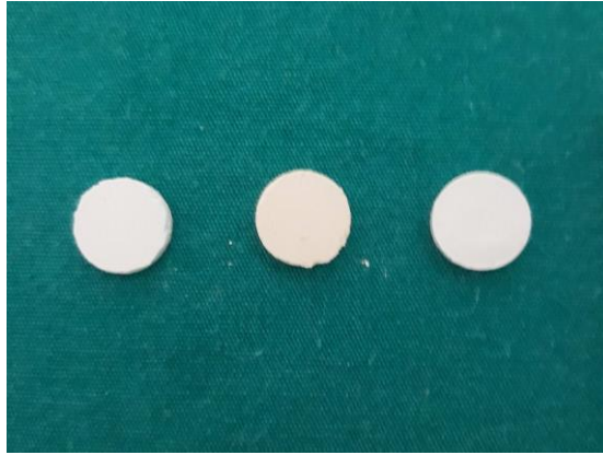
Şekil 3-4: Materyallerin 10 mm x 2 mm ölçülerindeki örnekleri
