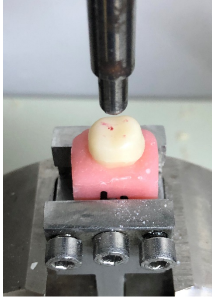
Şekil 13 Üniversal Test Cihazında Hazırlanmış Örnek
