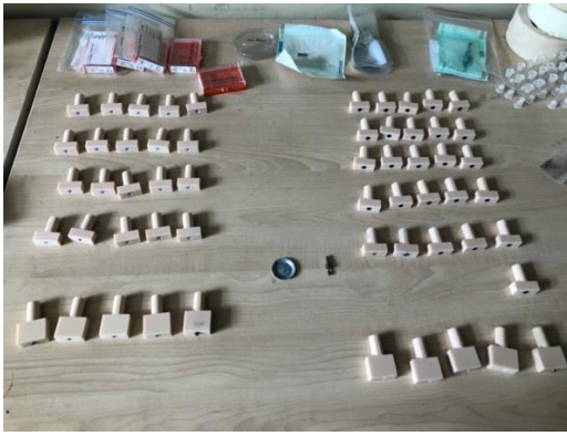
Şekil 3-13: Analog ve housinglerin akrilik rezin bloklara sabitlenmesi
