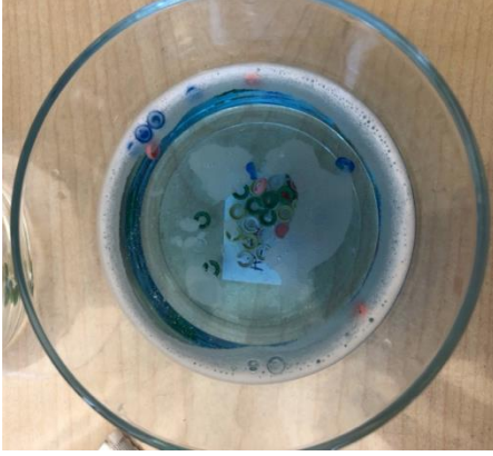
Şekil 3-6: AKT solüsyonunda bekletilen tutucu lastikler
