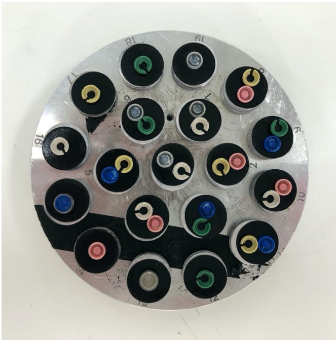
Şekil 3-21: SEM görüntüsü alınacak örneklerin tabladaki görünümü
