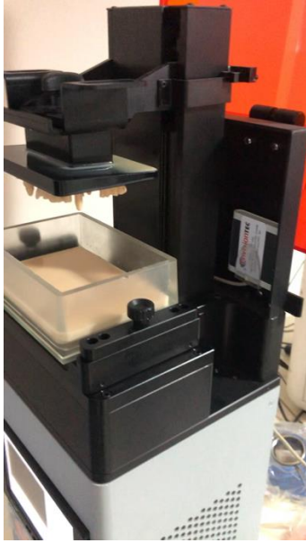
Şekil 3-11. Akrilik rezin blokların 3 boyutlu yazıcıda üretilme aşaması
