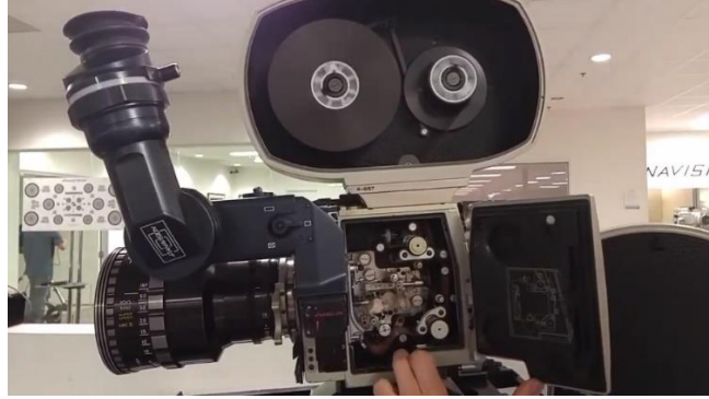
Şekil 2.1: Panavision Marka Bir Sinema Kamerasının İç Yapısı.
