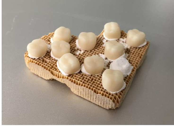
Şekil 30-IPS e.max CAD Örneklerin Kristalizasyon Sonrası Görünümü
