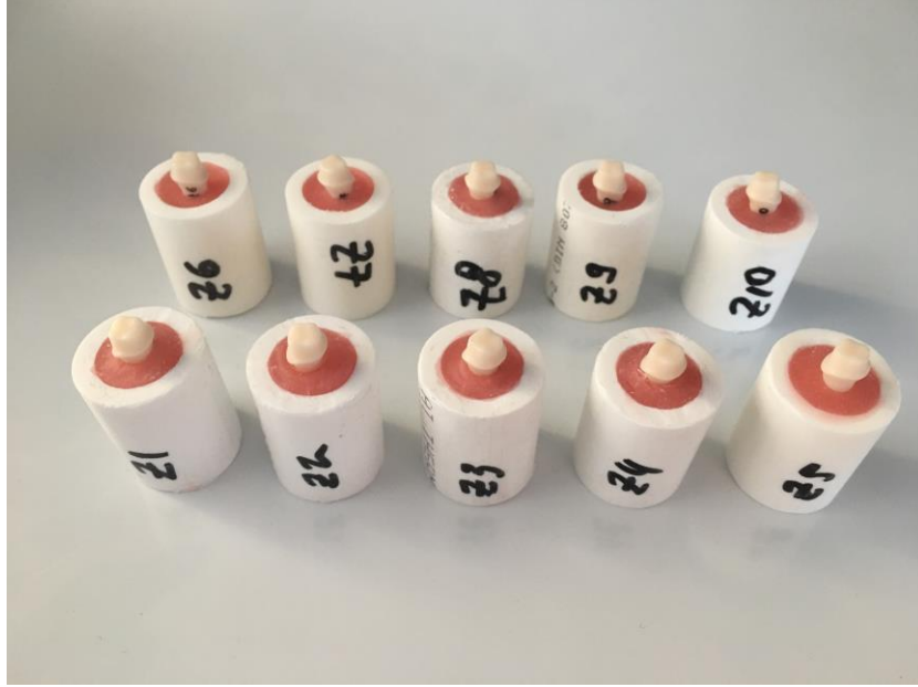
Şekil 52-Güdüklerin Otopolimerizan Akrilik İçinde Sabitlenmesi
