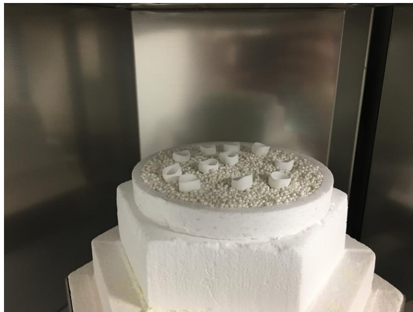
Şekil 32-Sinterizasyon Öncesi Zirkonya Örneklerin Görünümü
