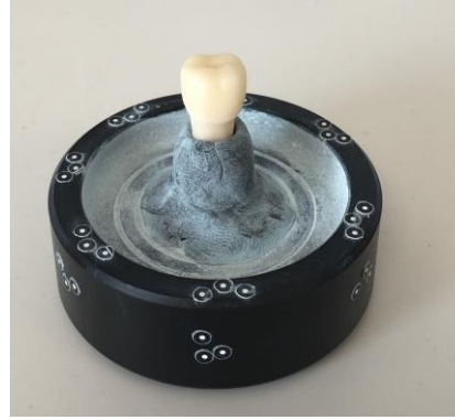
Şekil 37-Tarayıcı Tablasına Örneğin Yerleştirilmesi
