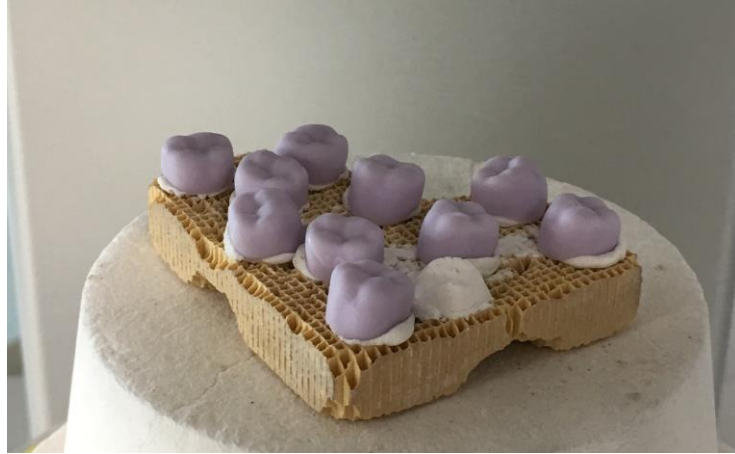
Şekil 29-IPS e.max CAD Örneklerin Kristalizasyon Öncesi Görünümü
