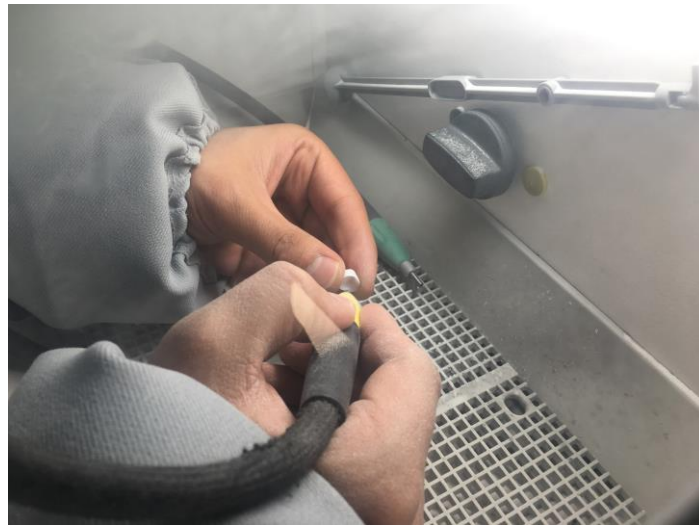
Şekil 49-Renfert Kumlama Cihazında Zirkon İç Yüzeylerinin Kumlanması
