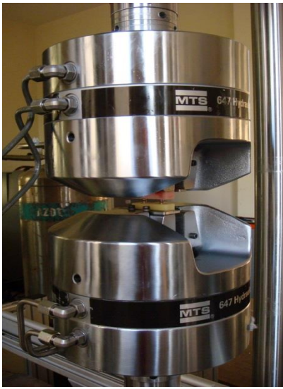
Şekil 3-32a: MTS 322 Test Frame Cihazı
