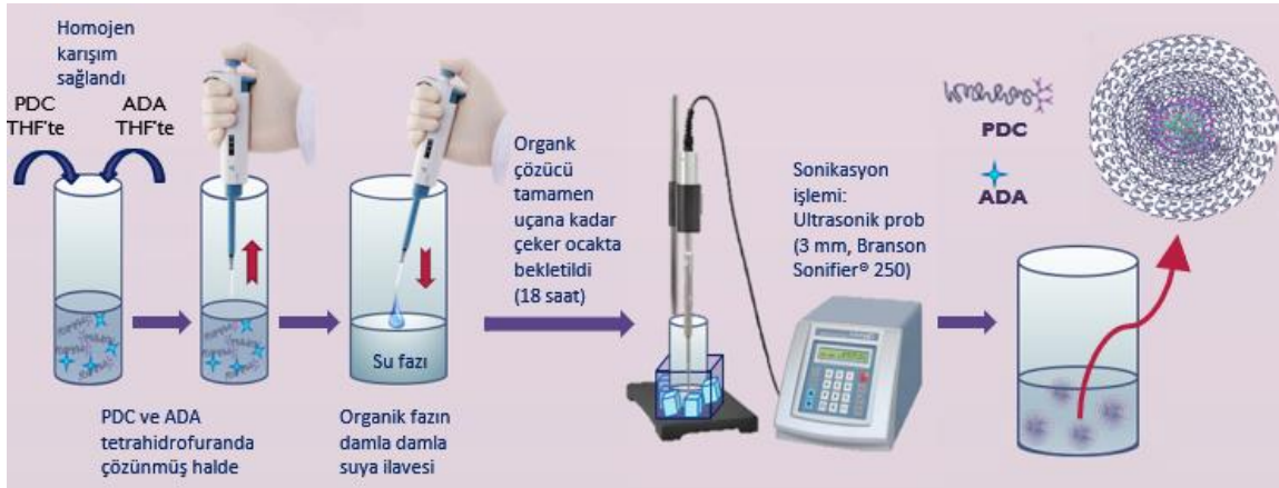
Şekil 3-3: Adapalen yüklü dendron temelli misel formülasyonlarının hazırlanması
