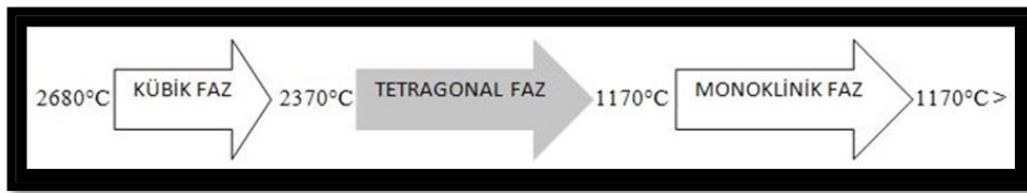
Şekil 1. Zirkonyanın kristal fazları ve dönüşüm sıcaklıkları [161].
