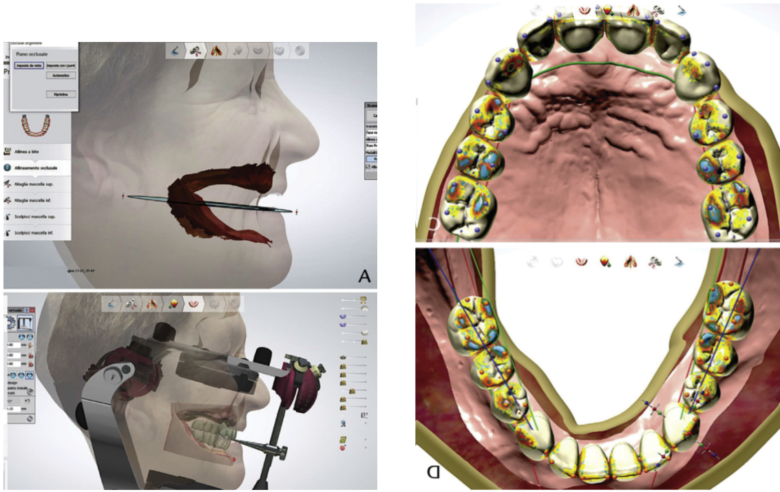
Şekil 8: Ağız içi taramaların artikülatöre aktarılması ve diş diziminin sanal ortamda yapılması[85].
