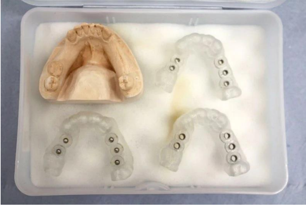
Şekil 17. Flepsiz implant cerrahisi için CAD/CAM üzerinde üretilen diş destekli cerrahi rehber plaklar. [52]
