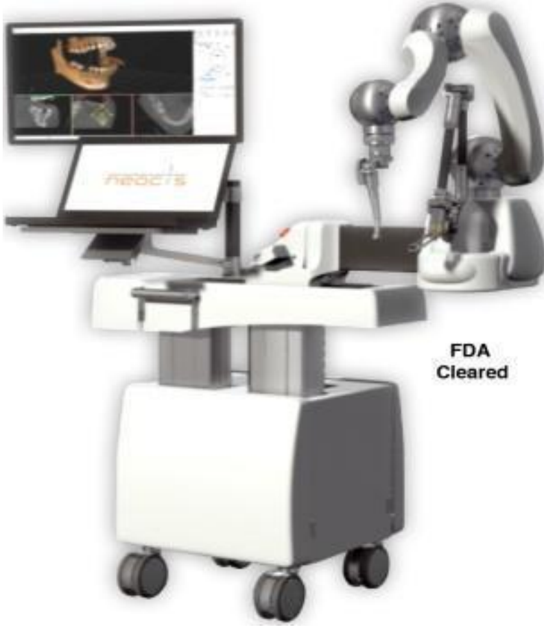
Şekil 23. Yomi robotik dental implantoloji cihazının gösterimi.[73]
