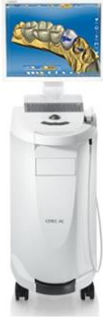
Şekil 12: Cerec intraoral kamera ve tasarımın yapıldığı yazılım[243]
