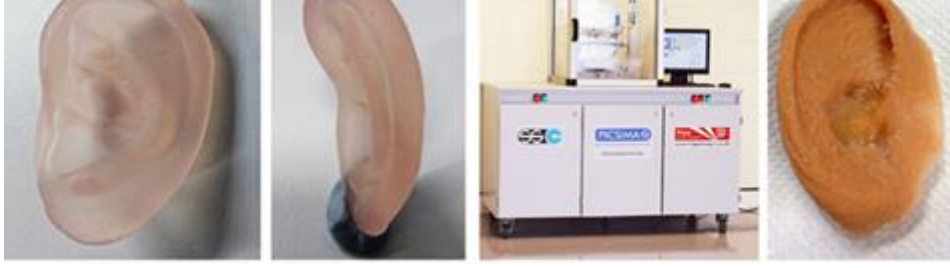
Şekil 28: PolyJet teknolojisiyle kulak protezi üretimi [323]
