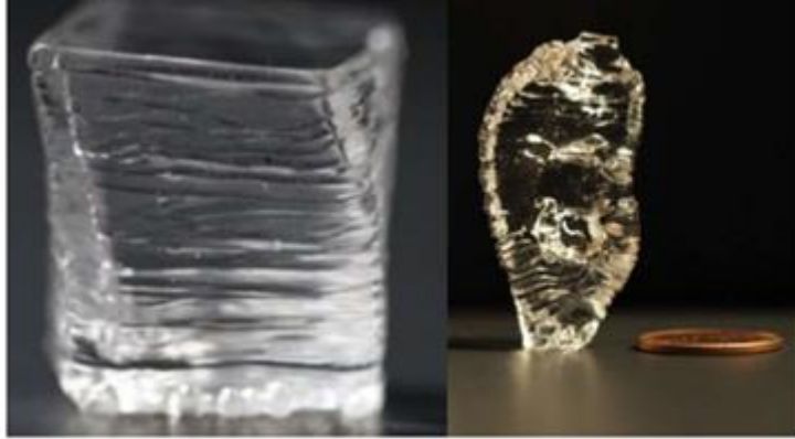
Şekil 29: Gömülü üç boyutlu baskı yazdırılmasında oluşmuş defektler ve distorsiyon[337]
