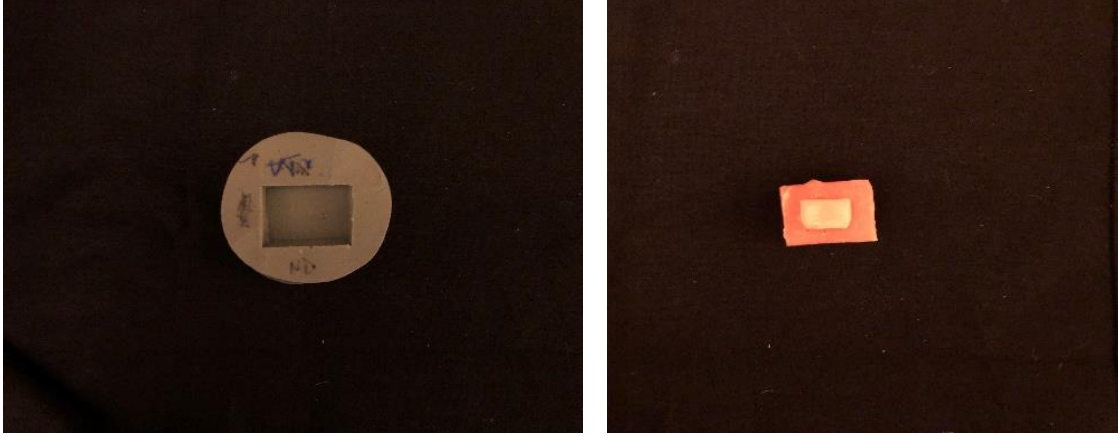
Resim 3.3 Örneklerin akriliğe gömülmesinde kullanılan silikon kalıp ve akrilik rezine gömülmüş örnek
