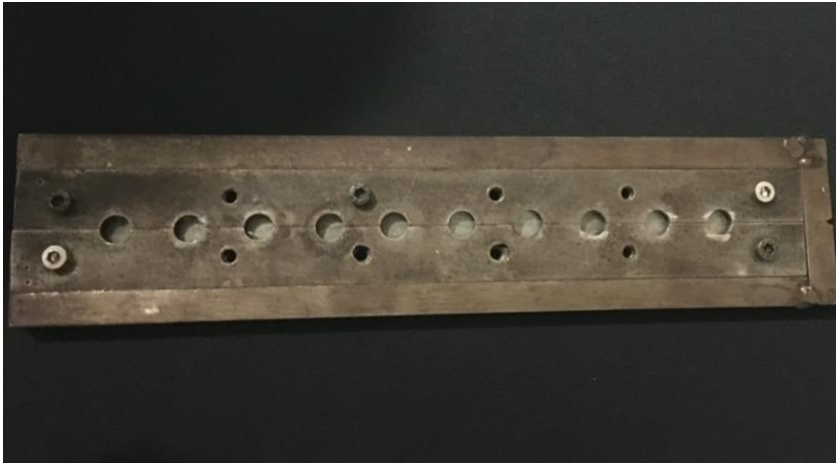
Şekil 3-10: Çalışmada kullanılan paslanmaz çelik kalıp (2x8 mm)
