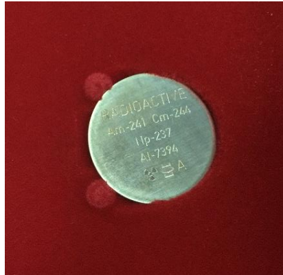
Şekil 3.8: Alfa Spektroskopi Sistemi kalibrasyonu için kullanılan karışık alfa kaynağı.
