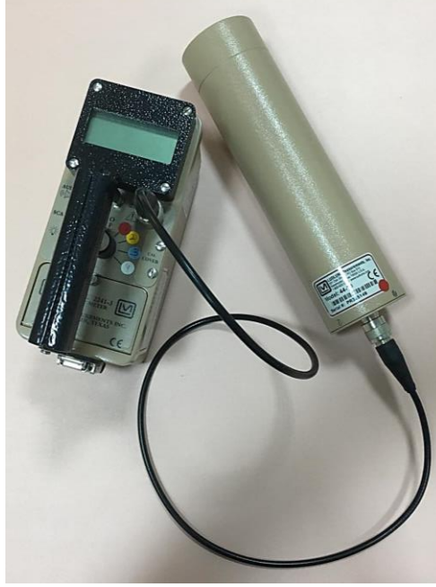
Şekil 3.18: Gama sintilasyon (NaI) probunu içeren taşınabilir doz ölçer sistemi.
