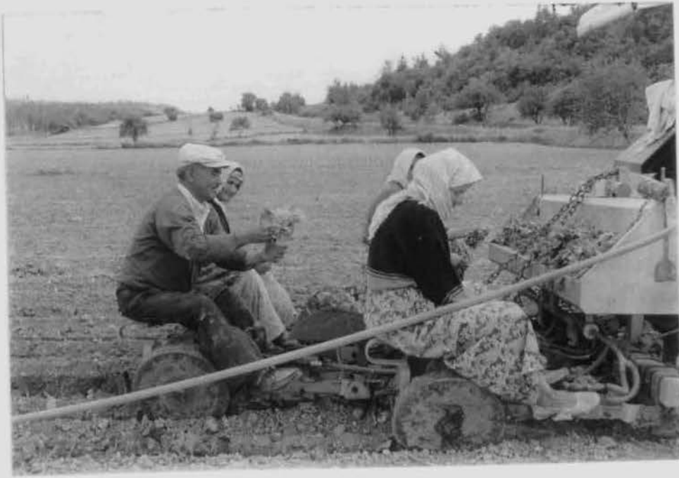
Fotoğraf – 38 Makina ile tütün fidesi dikimi
