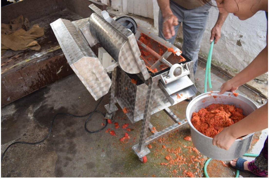
Fotoğraf 60: Bekletilen Domatesleri Daha Kolay Ezmek İçin Geliştirilmiş Salça Yapma Makinesi, 08/08/2017
