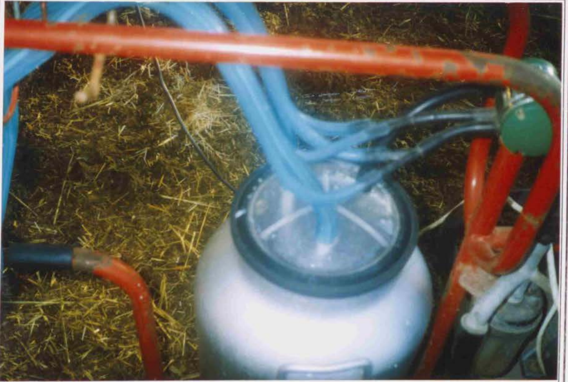
FOTOĞRAF-10- Süt Saęma Makinesi Bidonuna Sütün Dolması
