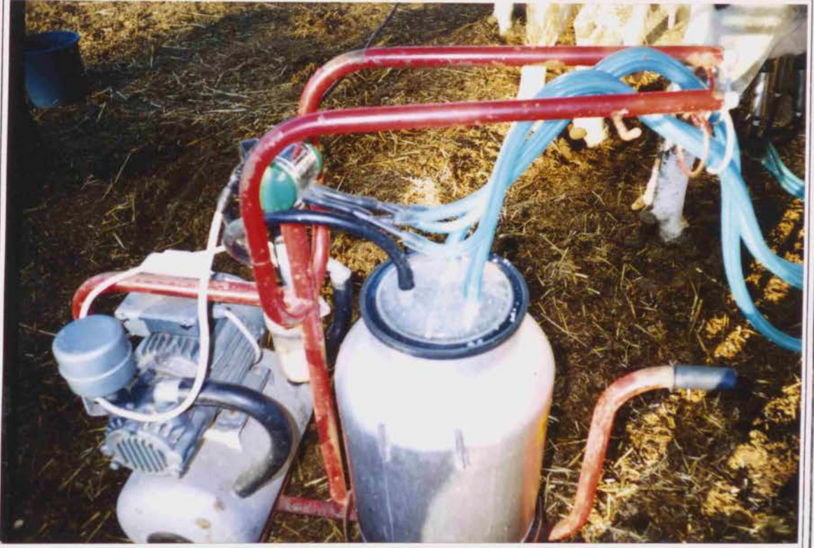
FOTOĞRAF-12- Süt Dolarken Süt Saęma Makinesinin Tamamının Görünüőü
