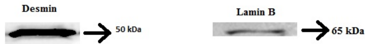
Şekil 4.1 Desmin ve lamin B proteinleri. 50kDa ağırlığındaki desmin ve 65kDa ağırlığındaki lamin B proteini total lizatta mevcuttur.
