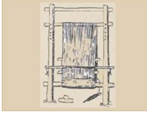
Şekil 73: Alt ve üst kirişlere sahip dikey dokuma tezgâhı
