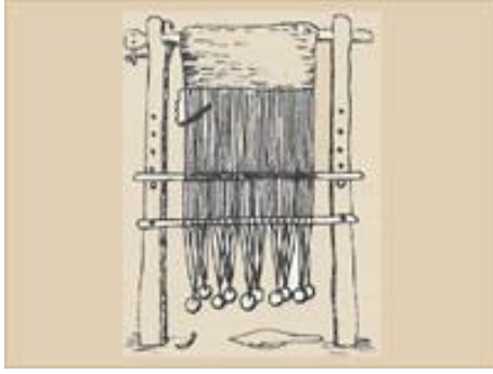
Şekil 74: Uçları ağırlıklı dikey dokuma tezgâhı
