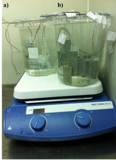
Şekil 3.10: Laboratuvar ölçekli iyonlu a) elektrokimyasal analizlere ait kuponları, b) biyofilm ile ilgili çalışmalarda kullanılacak kuponları içeren deney düzenekleri.
