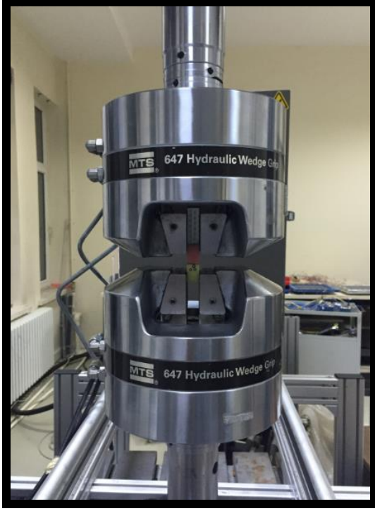
Şekil 3-21: Tutuculuk ölçümleri ve siklus deneyleri
