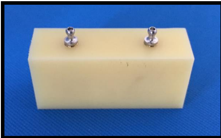
Şekil 3-13: Analoglara vidalanmış top başlı abutmentler
