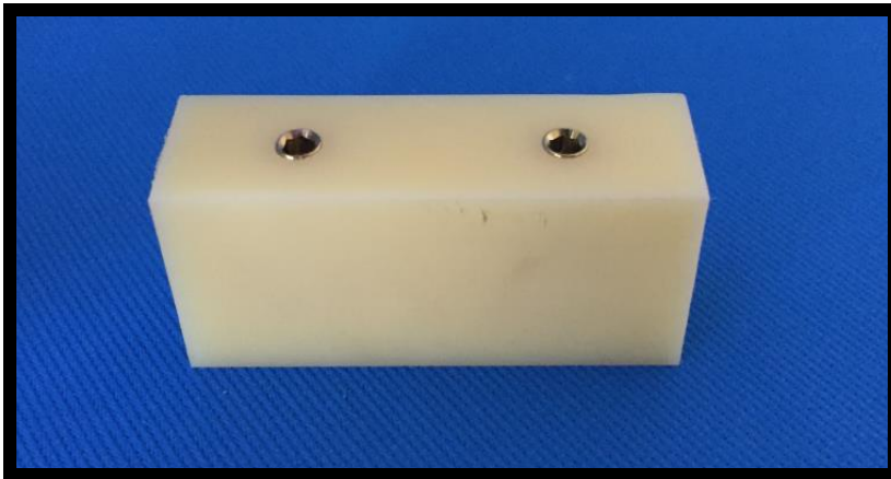
Şekil 3-5: Analogların kestamid bloğa eşit şekilde yerleştirilmesi
