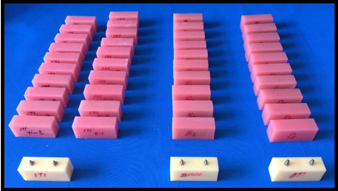
Şekil 3-17: Akrilik reçineden hazırlanan, 40 adet protetik componenti simüle eden bloklar
