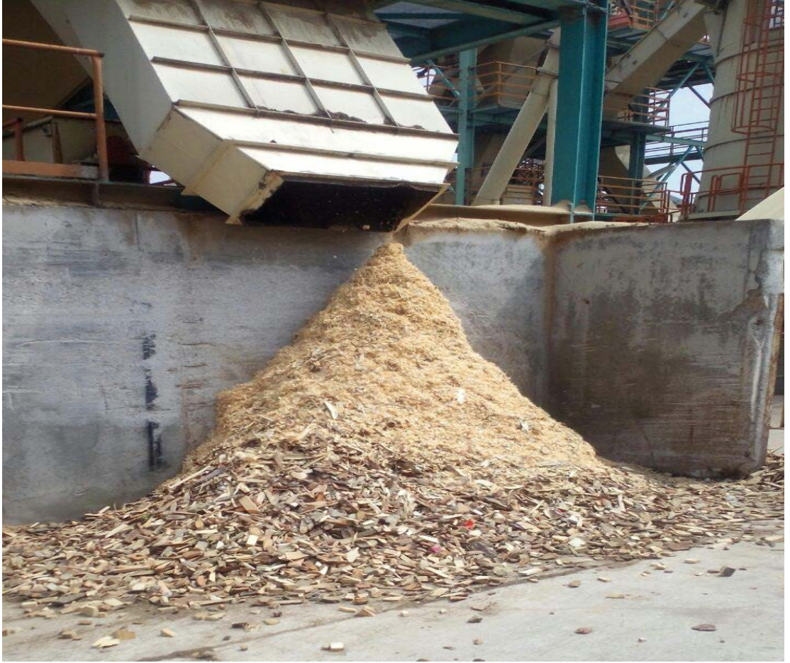
Şekil 2.8: Eleme aşamasında atık olarak oluşan ve takoz diye isimlendirilen odun parçaları.
