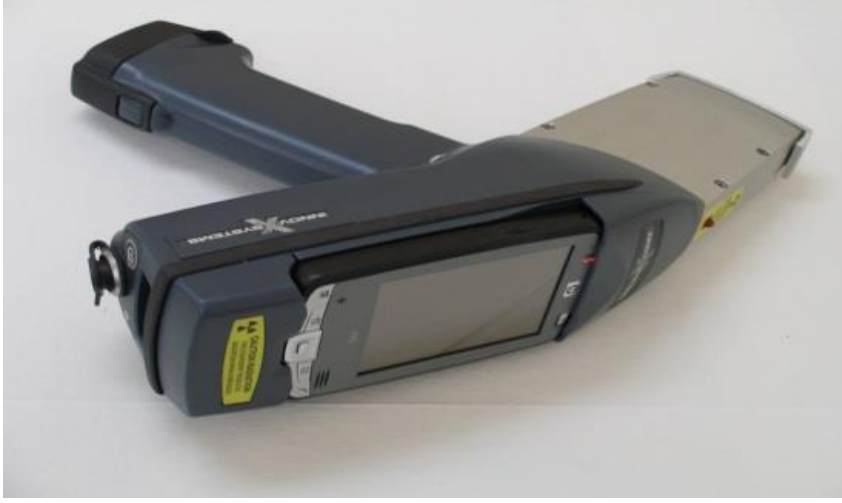
Resim 26. XRF Portatif Spektrometresi (Şinasi Ekici, 2013)
