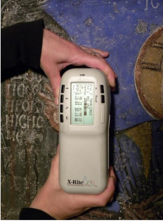
Resim 14. Taşınabilir spektrofotometre ile renk ölçümlerinin yapılması ve kayıt altına alınması (Özlem Toprak Arşiv, 2012 )
