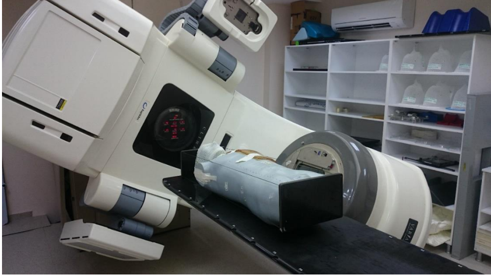
Şekil 3-12 : CIRS ATOM ® fantom üzerinde tedavi planı uygulaması
