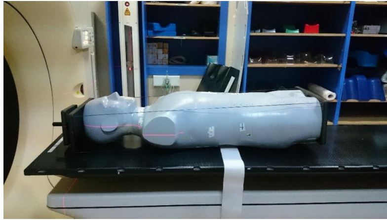
Şekil 3-5 : CIRS ATOM ® erkek fantomunun BT görüntülerinin alınması
