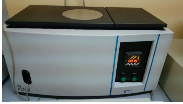
Şekil 3-4 : Fimel LTM marka TLD fırını
