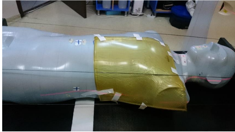
Şekil 3-6 : CIRS ATOM® erkek fantomunun bolus ile BT görüntülerinin alınması
