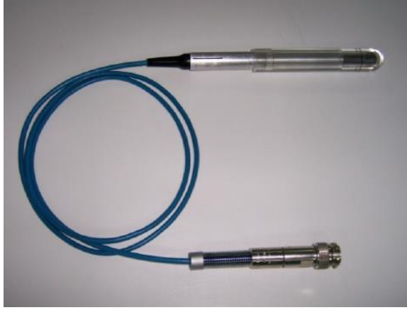
Şekil 3.9. PTW 30013 0,6 cm 3 Farmer Tipi Silindirik İyon Odası
