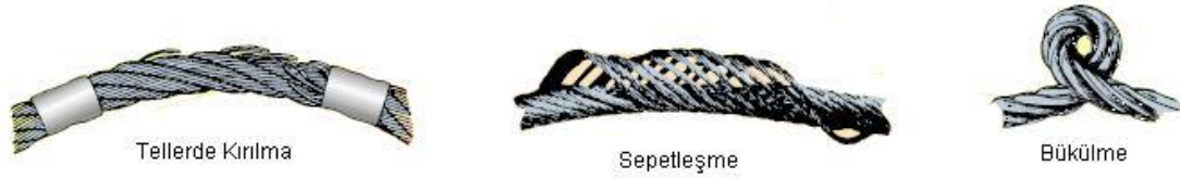
Şekil 17. Halatlarda meydana gelen bazı hasarlar [13]
