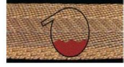
Asitler / bazlar nedeniyle hasarlanmış.
