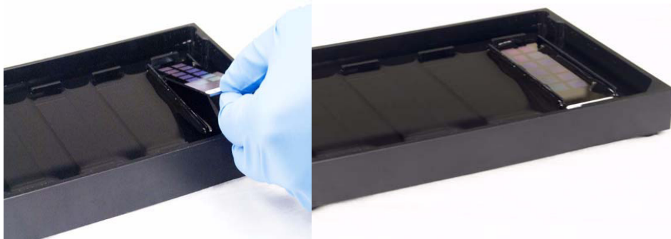
Şekil 3-12a ve 12b: Çipler içerisine PB1 solüsyonu konmuş olan hazneye alınmıştır (151)
