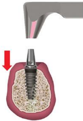
Şekil 3-19: Vidasız Morse taper bağlantının sabitlenmesi
