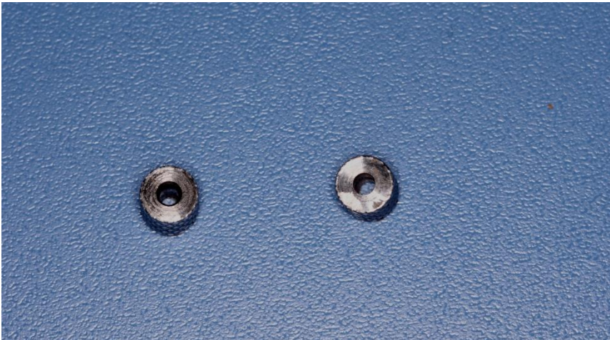
Şekil 3-4: Paslanmaz çelikten hazırlanan kılavuzlar
