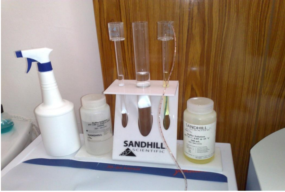
Resim 2 : pH-metre kateteri pH 4 ve 7 tampon solüsyonları ile kalibre edildi
