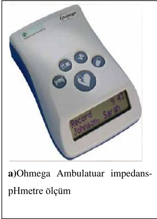
Resim 1a-b: Mobil kayıt cihazı ve impedans kateteri
